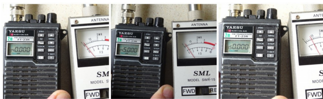
Εικόνα 6 Τα στάσιμα στους 140, 145 και 160 MHz
