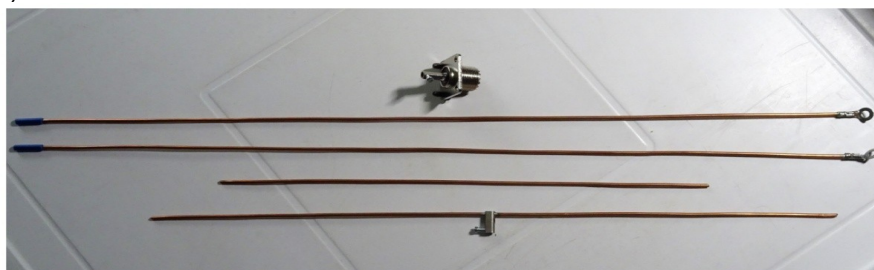
Εικόνα - Η κεραία αποσυναρμολογημένη και λεπτομέρεια από τον κονέκτορα UHF
